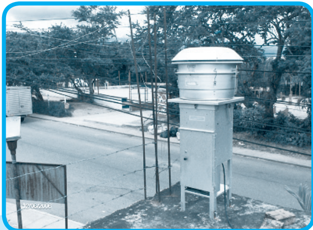
Figura 2. Instrumento manual tipo Highvol para el monitoreo de material particulado, Bucaramanga 2006-2008
